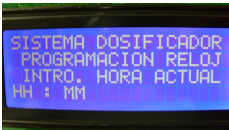
Figura 2. Visualización para la programación de la hora actual.
