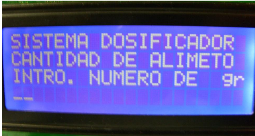
Figura 6. Visualización para la programación de la cantidad de alimento.
