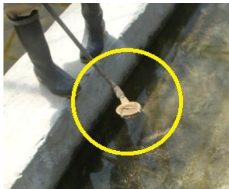
Figura 3. Elemento empleado para dosificar (pequeño colador)
