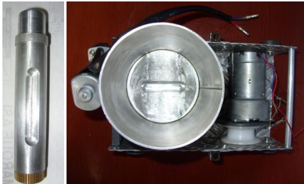
Figura 16. Dosificador de alimento
