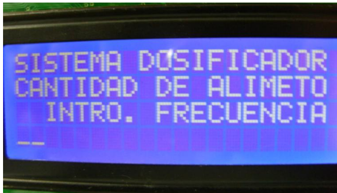
Figura 7. Visualización para la programación de la frecuencia de alimentación.
