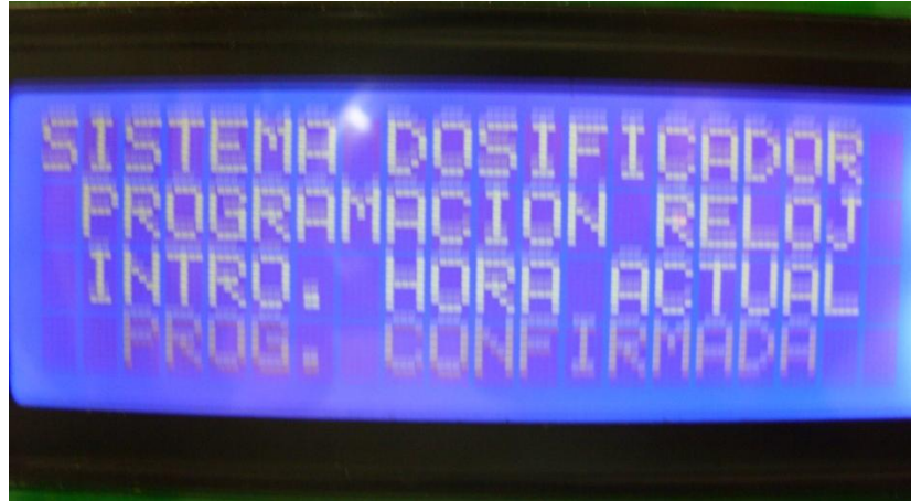
Figura 3. Visualización en la pantalla LCD después de programar la hora actual
