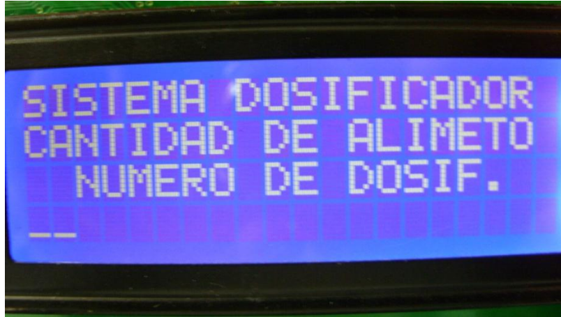
Figura 8. Visualización para la programación de la cantidad de dosificaciones diarias
