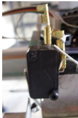
Figura 18. Pulsadores de inicio y fin de carrera
