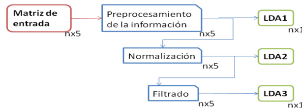
Figura 26. Diagrama de bloques LDA
