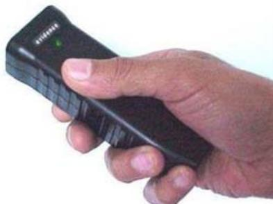
**3.2.2 Lector RFID RI-STU-655A.** Este dispositivo es fabricado por la compañía Texas Instruments y distribuido en Colombia por Plintec LTDA (Figura 25), perteneciente al catálogo de lectores HF Reader System Series 6000, el cual trabaja a una frecuencia de 13.56 MHz.
