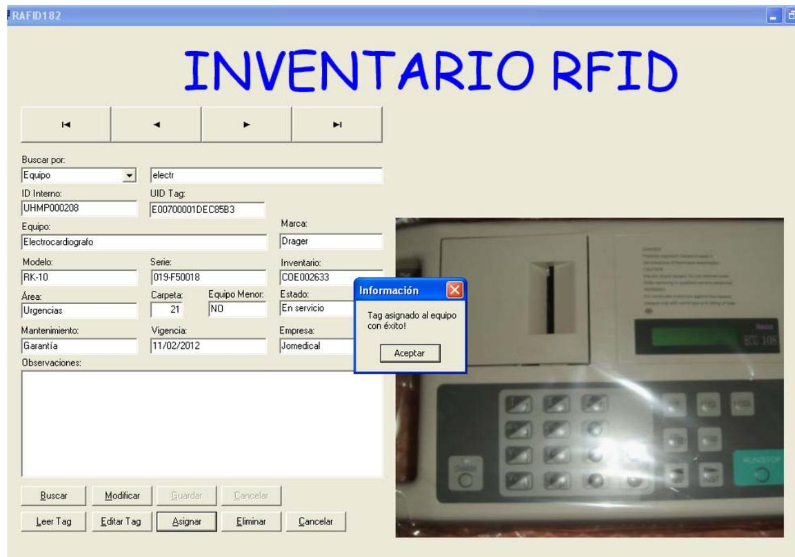
**2.4.3 Identificación de los equipos.** El proceso de identificación se hará mediante el uso de lectores RFID. Cuando el tag del equipo se encuentre dentro de la zona de la antena del lector, automáticamente el equipo podrá ser reconocido por la aplicación del sistema a través de su UID.
