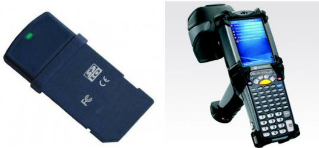
**1.3.3 Tag.** Los tags o transponders se componen básicamente de un chip conectado a una antena, que es el componente mediante el cual el tag detecta el campo generado por el lector y también emplea para responder a la interrogación.
