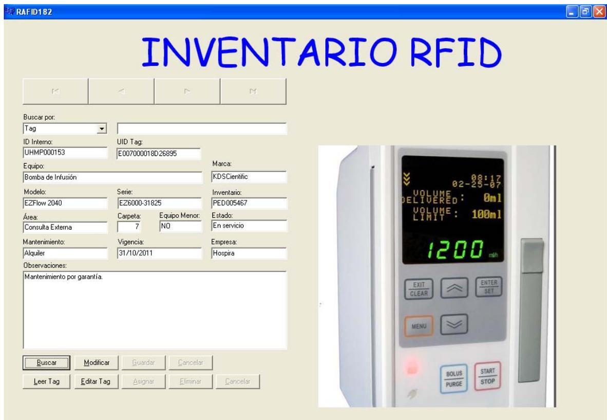
**2.4.3.1 Identificación de varios equipos.** Cuando varios tags se encuentren dentro del campo de acción de un lector RFID, cada equipo será identificado por la aplicación del sistema. Para este caso, el lector RFID cuenta con la capacidad de leer tags de manera simultánea, gracias a la incorporación del sistema anticolidión.
