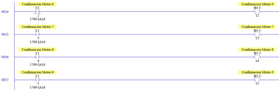
Figura 43. Tag's de confirmación de operación Motores del 6 al 9.
