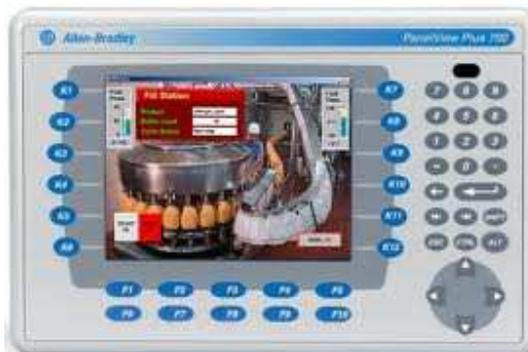
Figura 11. HMI, Interface Humano Maquina, a color, con teclado.
