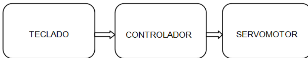
Figura 21. Diagrama de bloques del diseño electrónico del actuador
