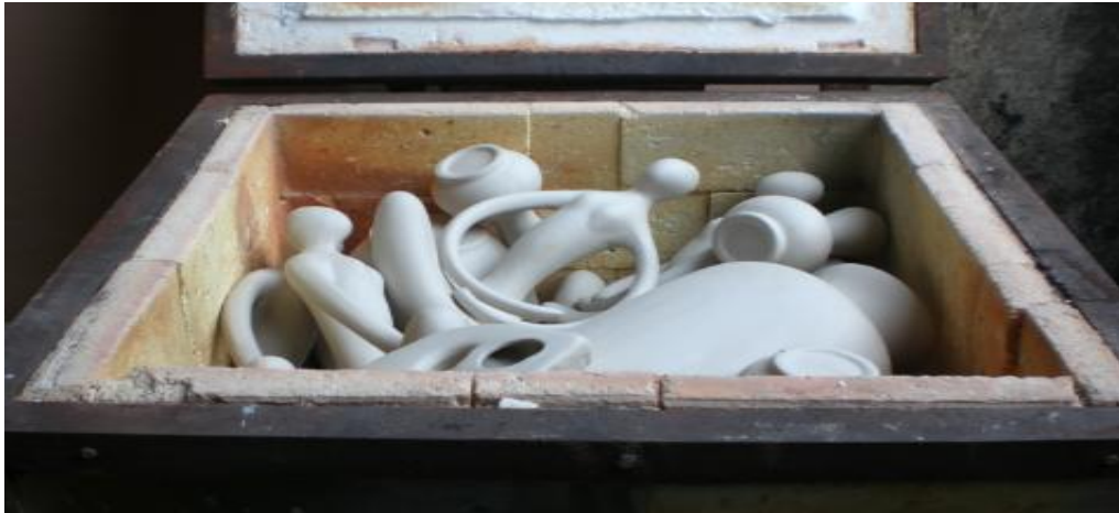
Figura 4. Horno preparado para el bizcochado
