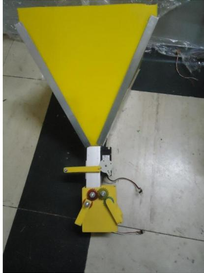
Figura 43. Foto del Sistema de vaciado y sujeción de las bolsas
