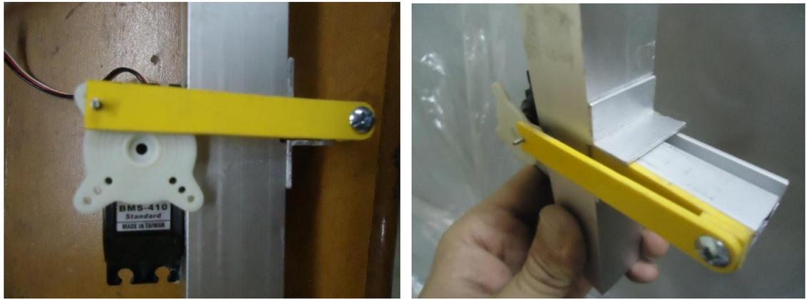
Figura 41. Foto de Puerta de control de vaciado
