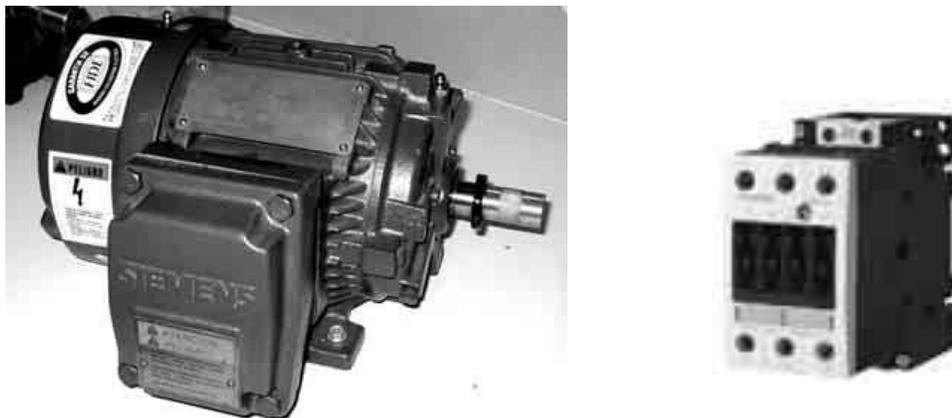
Figura 23. Motor Siemens trifásico 1.5 HP y Contactor Siemens Sirius 3RT/1036
