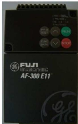
Para la programación del variador se debe tener en cuenta los parámetros del motor que se vaya a controlar como lo son la cantidad de polos que posee, la potencia, el voltaje de alimentación, RPM máximas, etc.
