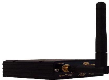
**2.3.1.4 Protocolos de comunicación:** A través de este protocolo se logra que la información que se encuentra almacenada en el concentrador de señales sea transportada hasta el centro de control. Los modem Enfora utilizan el protocolo TCP de la capa de transporte el cual a su vez utiliza el protocolo IP de la capa de red.
