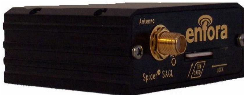
Para poder utilizar este modem, básicamente se debe contar con un nivel de señal teóricamente igual o superior a 15 db aunque en la práctica recomendamos que sea de 17 dB en adelante. La configuración de este modem celular de acuerdo con al tipo de comunicación y se realiza utilizando el Hyper terminal y los comandos AT que este soporta.
