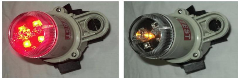
Aún cuando el indicador se encuentre destellando por una falla transitoria, podrá detectar e indicar una falla permanente posterior. En estas condiciones se apagará el LED amarillo y se iniciará la indicación intermitente del LED rojo como se ve en el lado derecho de la Figura 7. Para la programación de este dispositivo es necesario tener claro el concepto de los Tipos de Disparos a los que responde el dispositivo.
