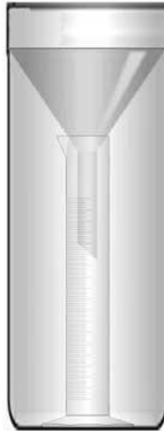
Figura 4. El pluviómetro “oficial” especificado por la Agencia Meteorológica de los Estados Unidos.
