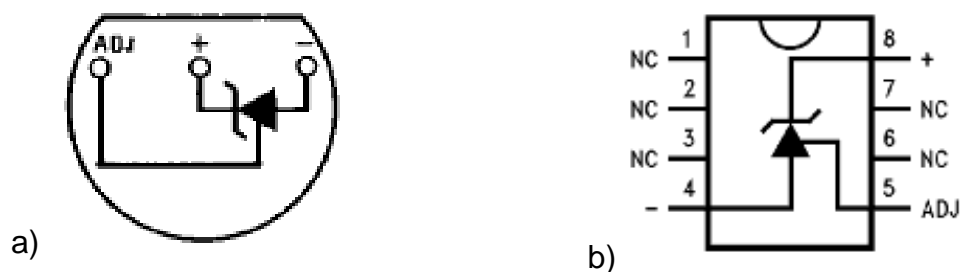
Figura 2. Sensor de temperatura de precisión a) Encapsulado de plástico, vista inferior b) Encapsulado de montaje superficial.
