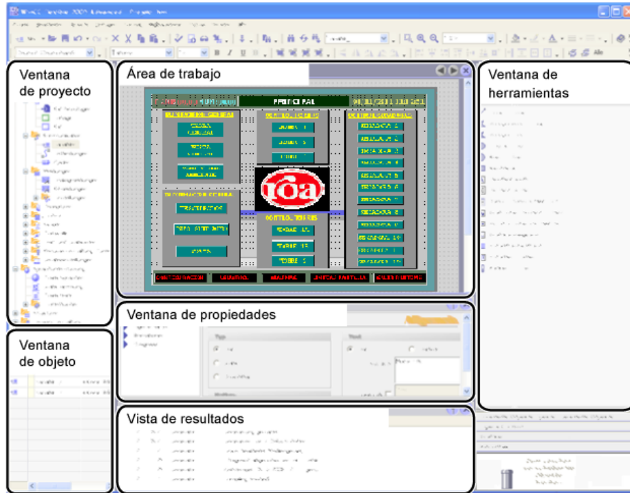
Figura 45. Interfaz del Wincc Flexible.
