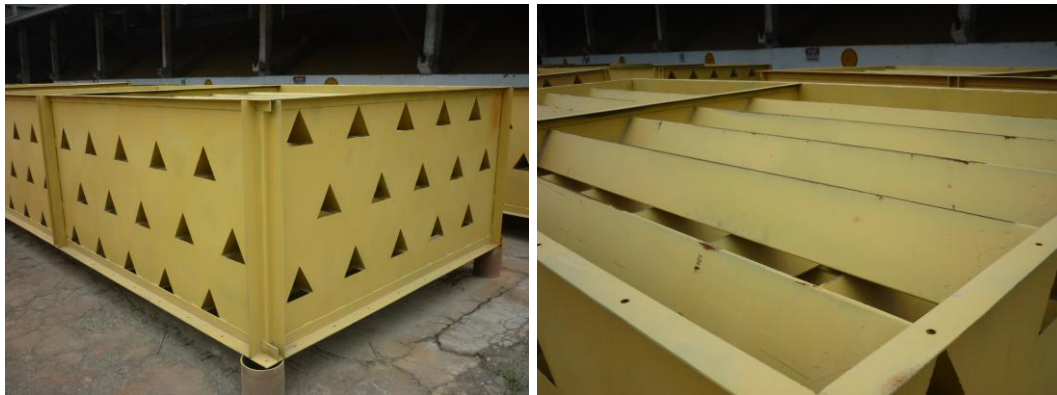
Figura 8. Panel de torre secamiento, vista frontal y superior.
