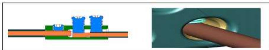
**Figura 4.** Tornillo sobre el aislamiento del conductor
