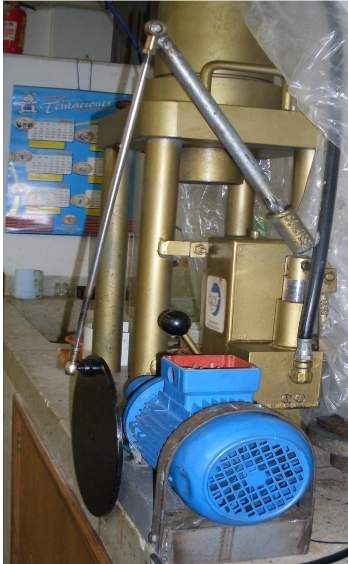
Figura 6 Mecanismo de accionamiento de la bomba
