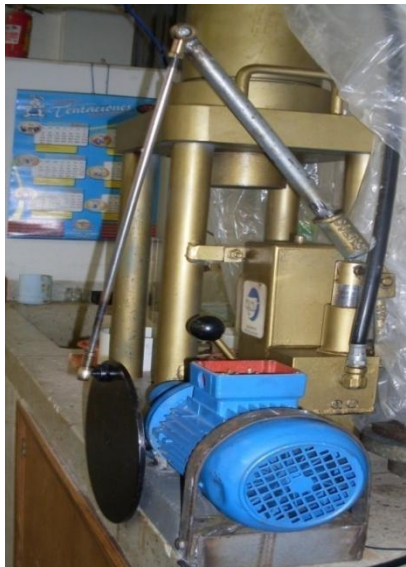
Fig. 1. Mecanismo de accionamiento de la bomba
