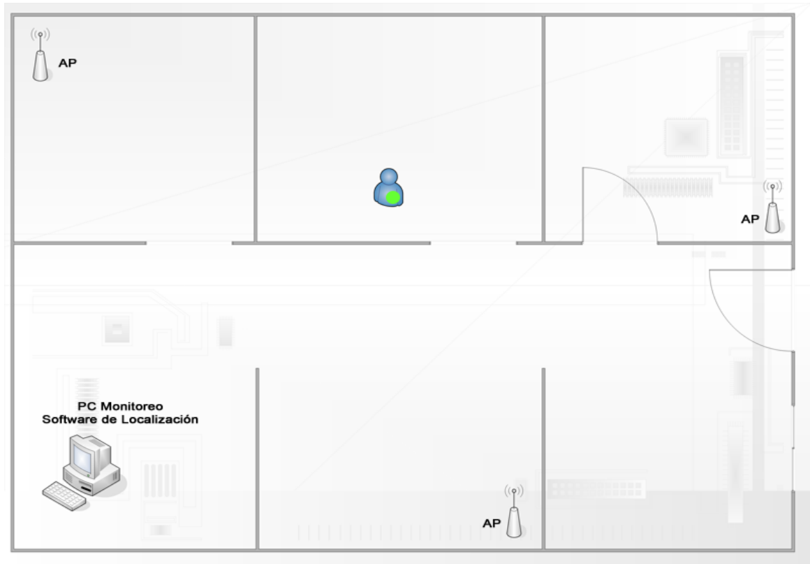
Figura 10. Infraestructura del sistema de localización planteado
