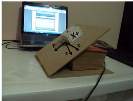
Figura 28. Maqueta para medir el ángulo yaw
