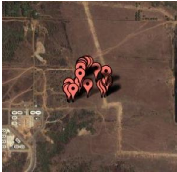
Figura 40. Recorrido del UAV entregado por el GPS
