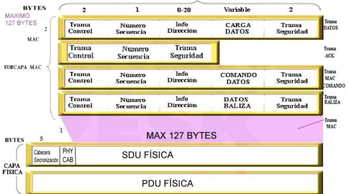
Figura 25. Empaquetamiento y direccionamiento Zigbee
