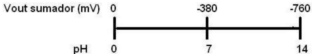
Figura 47 Rango voltaje salida del sumador inversor
