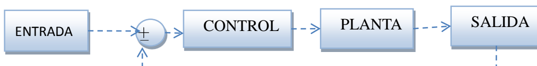
Fig. 8. Diagrama en bloque del sistema controlado
