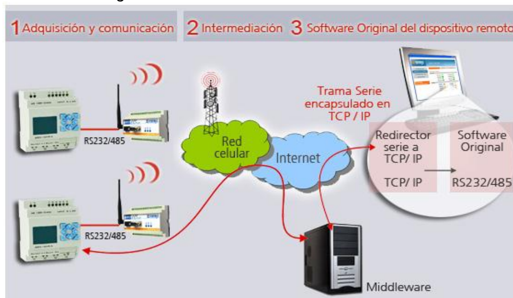
Figura 21. Sistema de Comunicación GPRS
