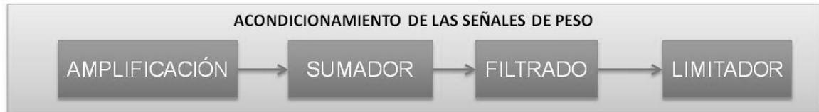
**Amplificación:** el microcontrolador requiere para sus entradas analógicas niveles de voltaje superiores a los entregados por las señales de peso de las celdas por esta razón se necesita una etapa de amplificación.
