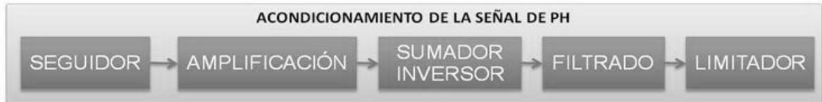
**Seguidor:** para esta etapa se usó el amplificador operacional CA3130 de entradas/salidas CMOS y alta impedancia de entrada.
