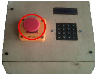
Figura 32. Botón de arranque y parada de emergencia
