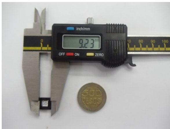
Figura 17: Giroscopio y acelerometro producido por Analog Device
