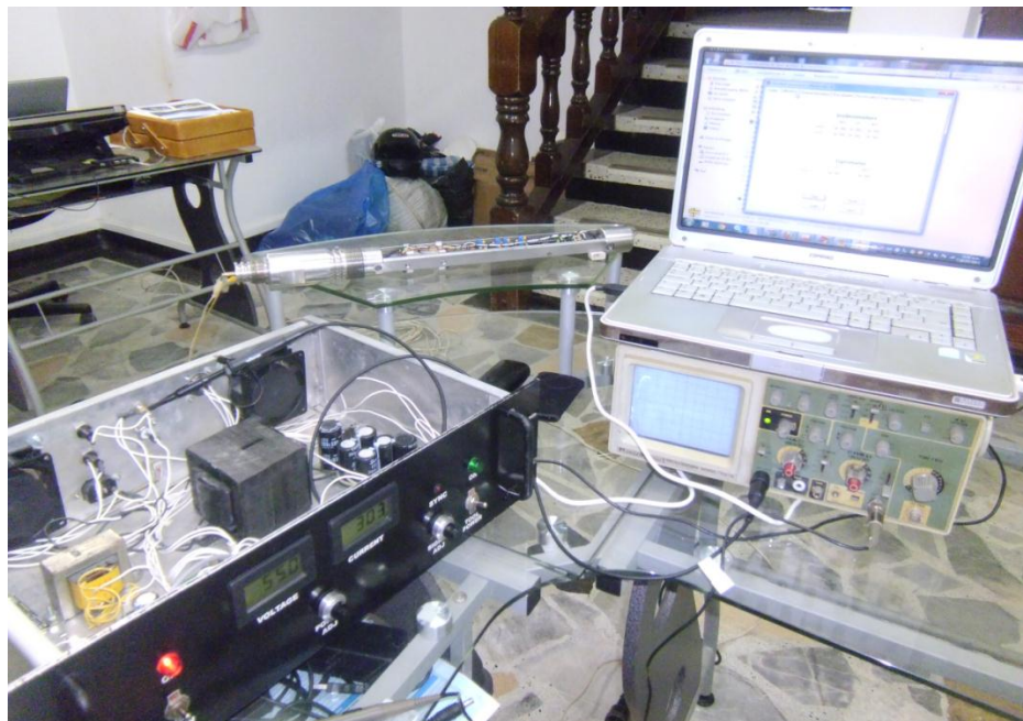
Figura 70: Conexión total de herramienta de fondo, Interfaz de comunicación y computador del usuario
