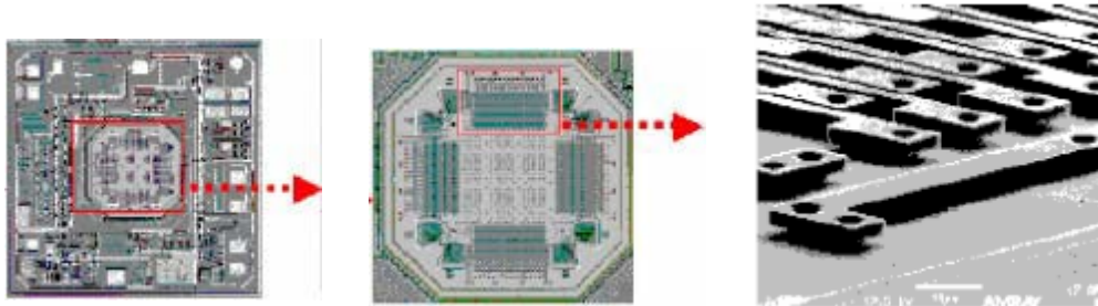
Figura 12: chip de 2mm 2 , sensor MEMS de 400μm 2 , brazos de 1μm
