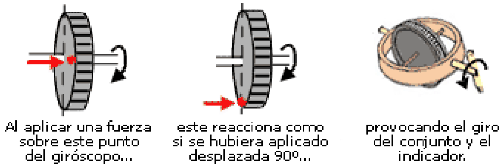
Figura 32: Funcionamiento del indicador de Viraje
