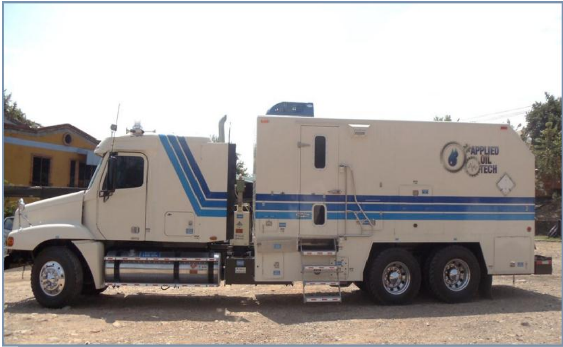
Figura 39: Camión de registro de electric line
