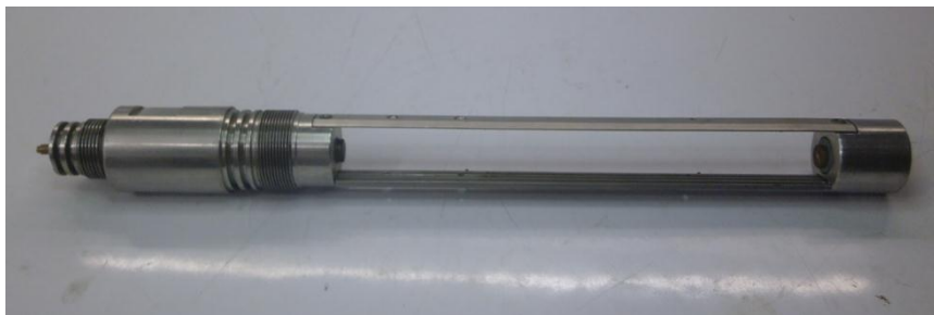
Figura 48: Chasis de la herramienta de fondo
