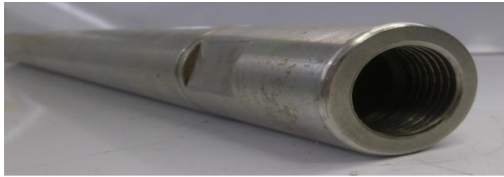
Figura 49: Housing de la herramienta de fondo
