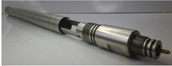
Figura 52: Acople del housing con el chasis de la herramienta de fondo
