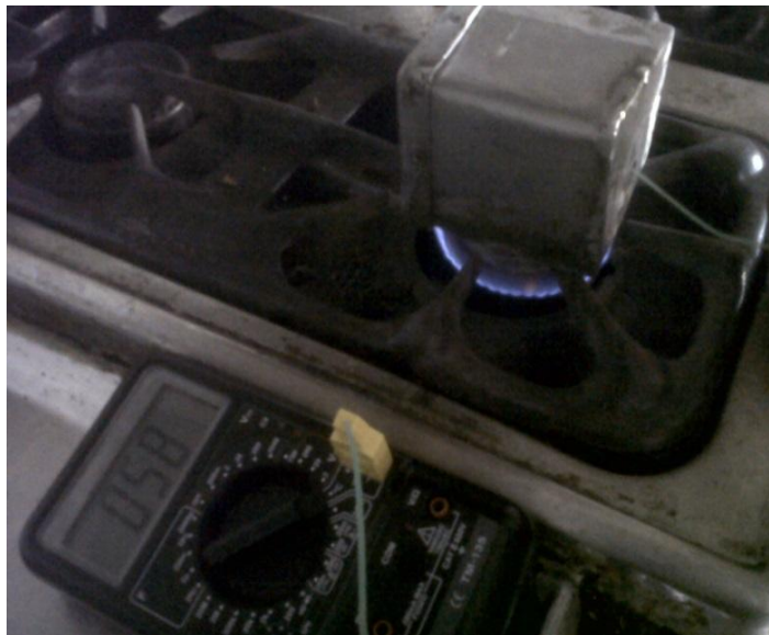
Prueba de aislamiento de la fibra de vidrio
