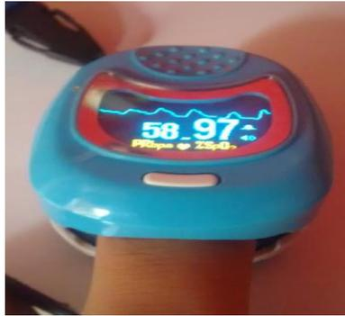
El pulso cardiaco con un valor de 60 pulsaciones por minuto y la saturación de oxígeno con un 96% fueron los valores obtenidos en el sistema de monitoreo del proyecto, visualizado en la aplicación móvil visto en la Figura 44. Comparando los resultados anteriores frente a los que arrojó el pulsioxímetro CMS50QB donde se obtuvieron 58 pulsaciones por minuto y 97% de oxígeno en la sangre visto en la Figura 45.
