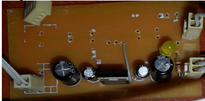
Figura 6. Fuente de alimentación de los motores
