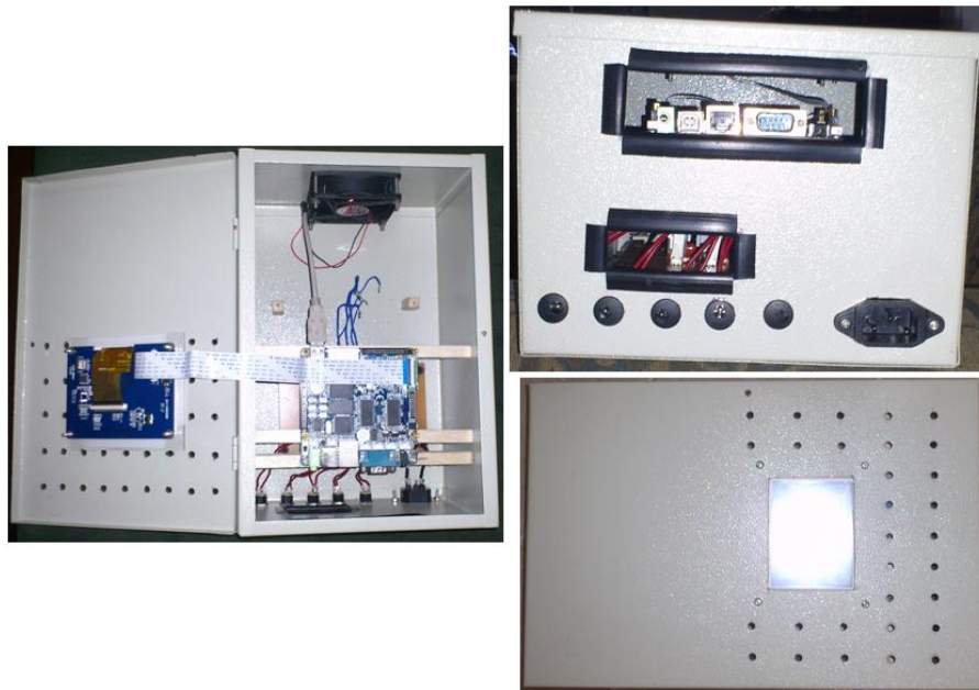
Figura 28. Caja metálica para la board ARM mini2440 y la etapa de potencia
