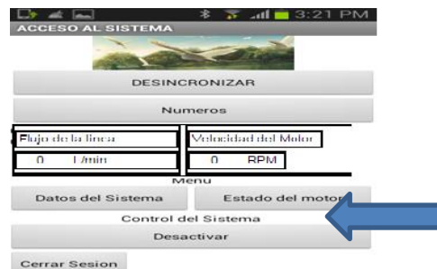
Ilustración 24: Interfaz para visualizar el estado del motor
