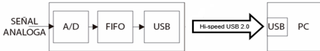
Figura 46. Esquema de transmisión USB
