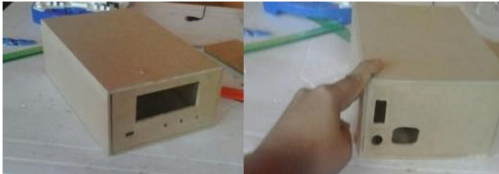
Figura 65. Caja protectora del circuito
