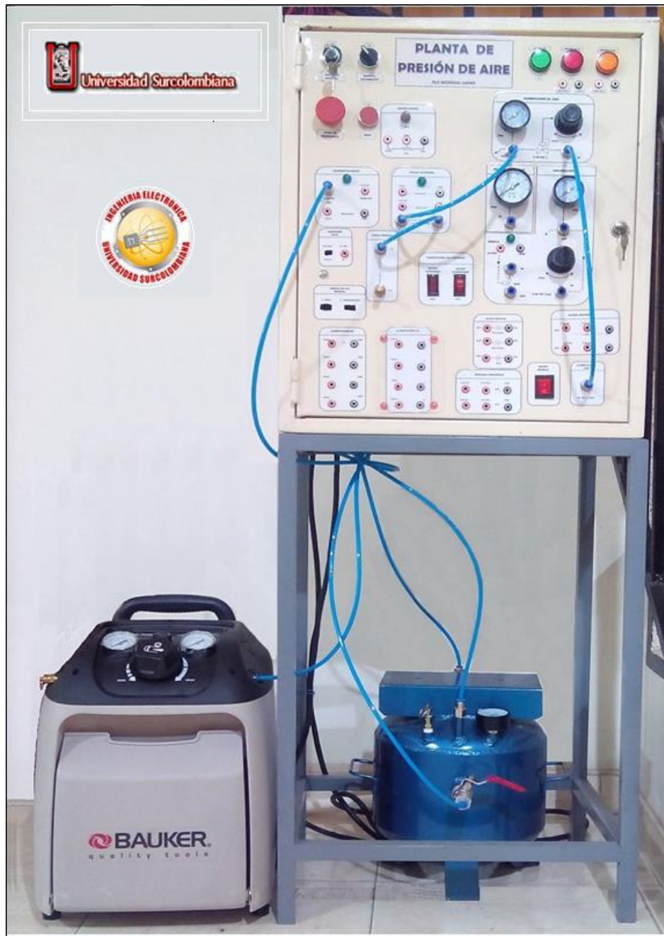
Figura 15. Planta de presión terminada
