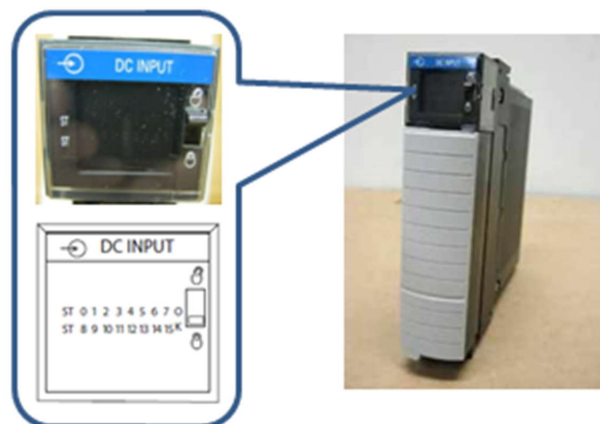
Figura 27. Módulo 1756-IB16I y LED's de estado
