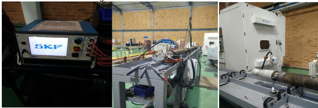
Figura 22. Prueba de aislamiento eléctrico
