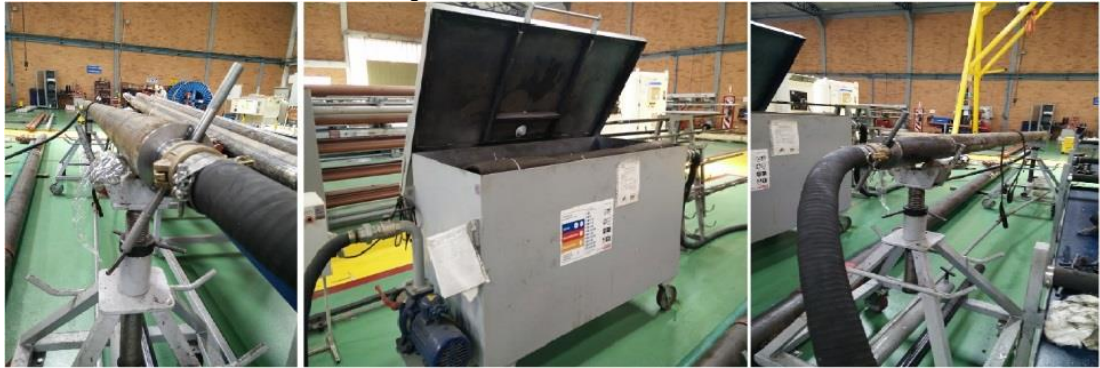
Figura 20. Lavado de estatores
