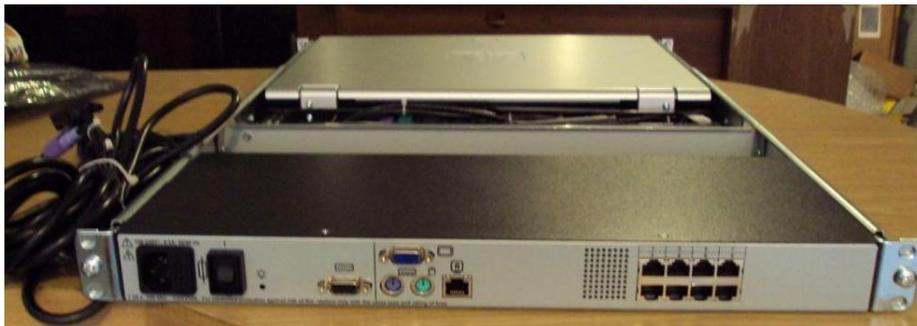
La conexión de los servidores se hace a través de un adaptador de interface HP de PS/2, USB y Virtual Media a KVM de HP TFT7600 G2, para soporte media virtual en servidores Proliant. No requiere software para ser instalado.
