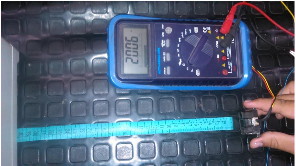
Figura 66. Prueba del sensor GP2Y0A02YK para una distancia de 30cm.
