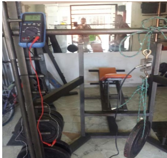
Figura 61. Prueba de la celda de carga con un disco de 25lb (11.34kg).
