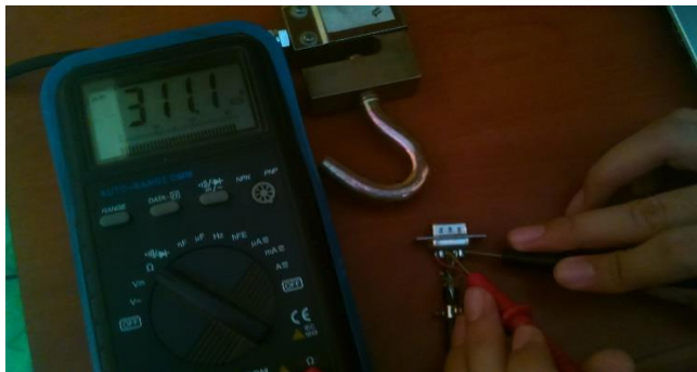
Figura 57. Medición de R_3 del puente de wheatstone de la celda de carga SA.
