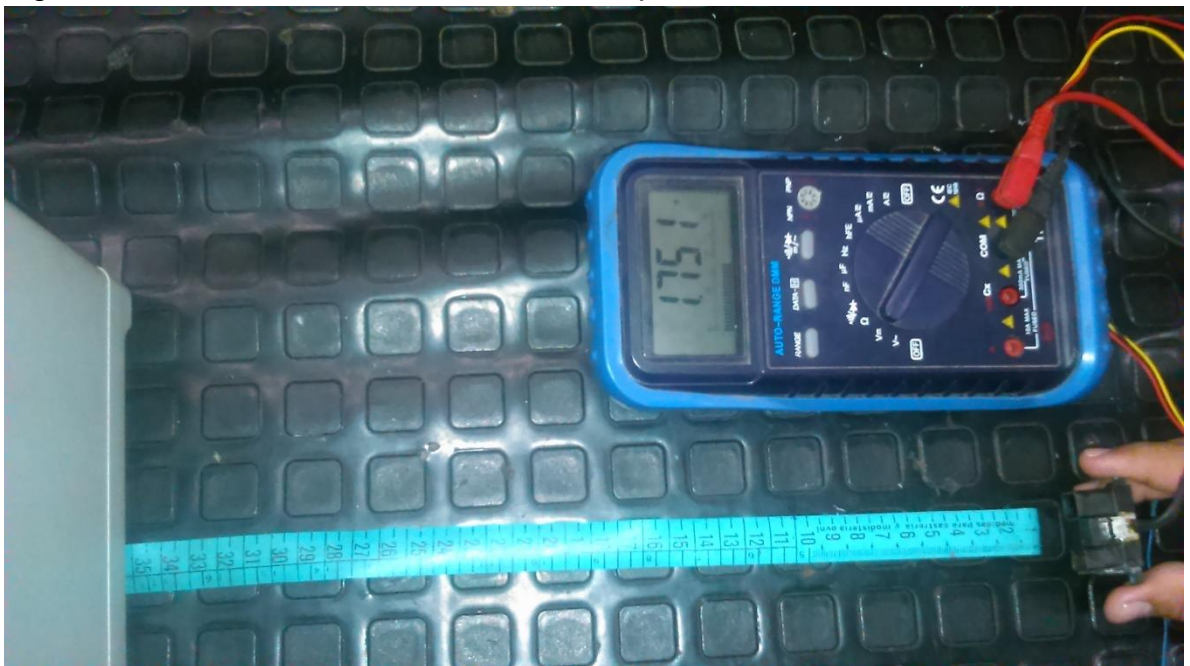
Figura 67. Prueba del sensor GP2Y0A02YK para una distancia de 35cm.
