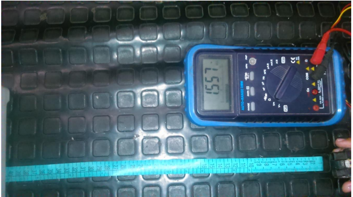
Figura 68. Prueba del sensor GP2Y0A02YK para una distancia de 40cm.
