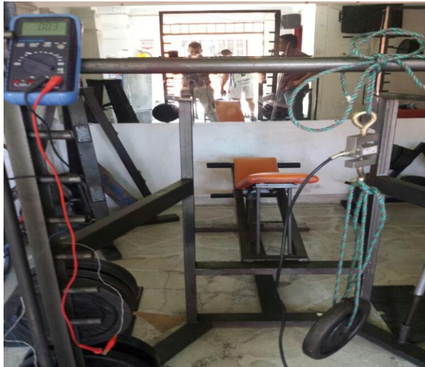
Figura 59. Prueba de la celda de carga con un disco de 10lb (4.54kg).
