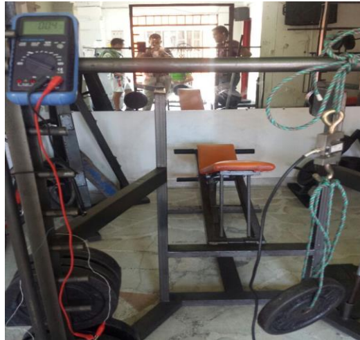
Figura 60. Prueba de la celda de carga con un disco de 12lb (5.44kg).
