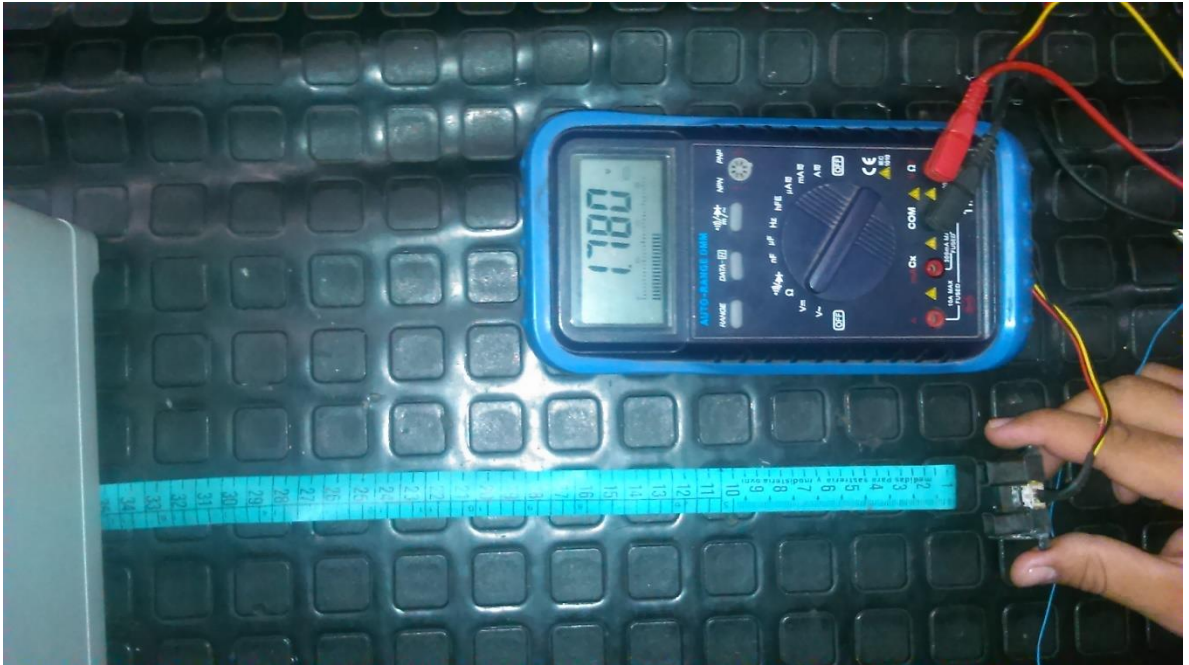
Figura 70. Prueba del sensor GP2Y0A02YK para una distancia de 34.5cm.
