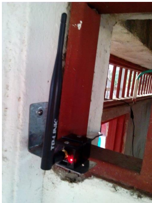
Figura 65. Prueba de funcionamiento (XBee PRO s2B-Coordinador)
