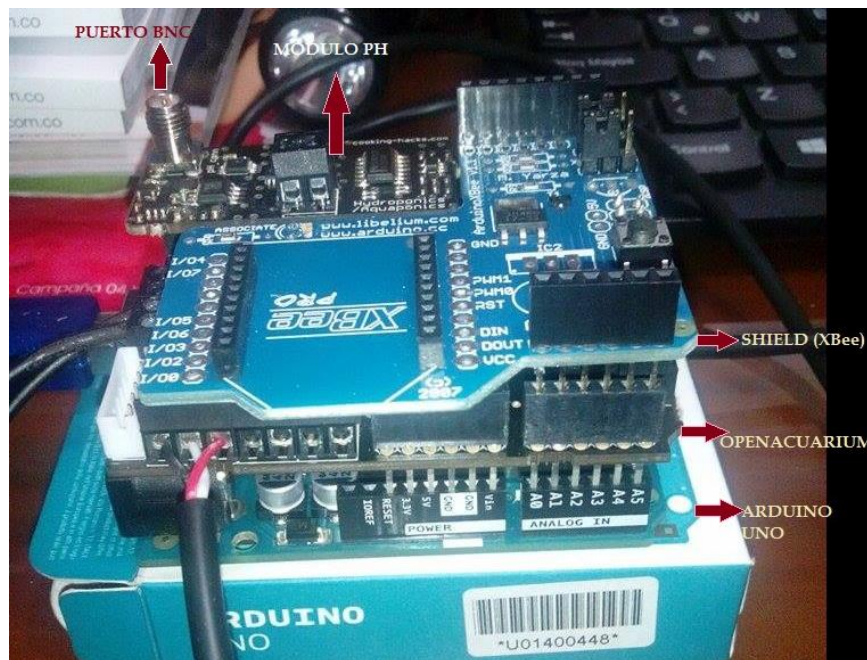
Figura 21. Tarjetas Arduino Uno, OpenAquarium, Shield de la XBee Pro S-2 y Modulo del sensor de pH
