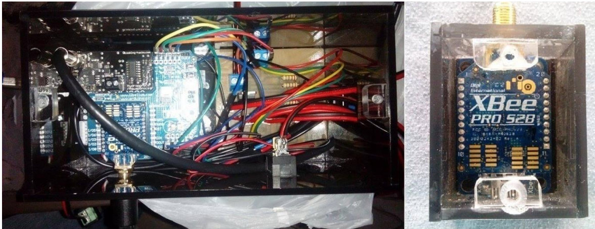
Figura 58. Sistema de monitoreo con sus módulos XBee Pro S2B (Circuito interno)
