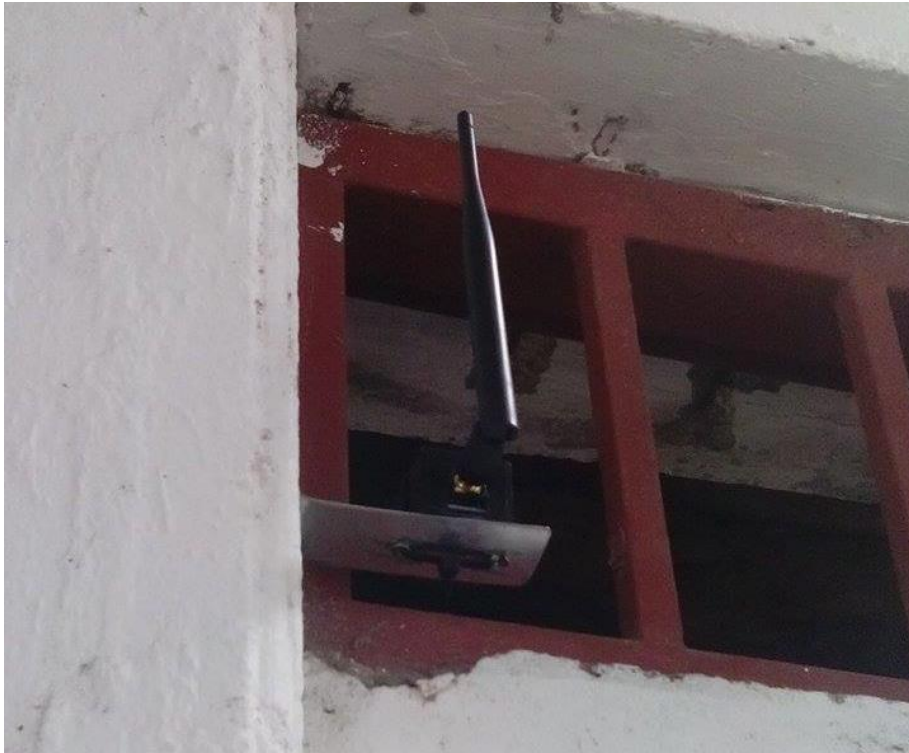
Figura 64. Módulo XBee PRO s2B coordinador instalado
