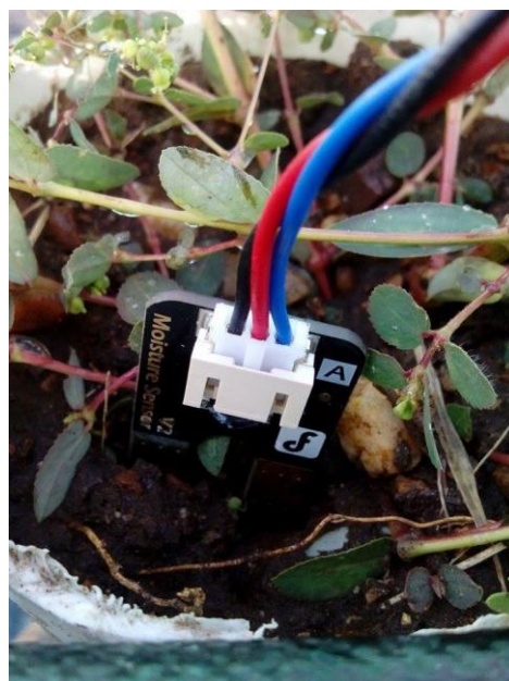
Figura 68. Sensor de humedad instalado
