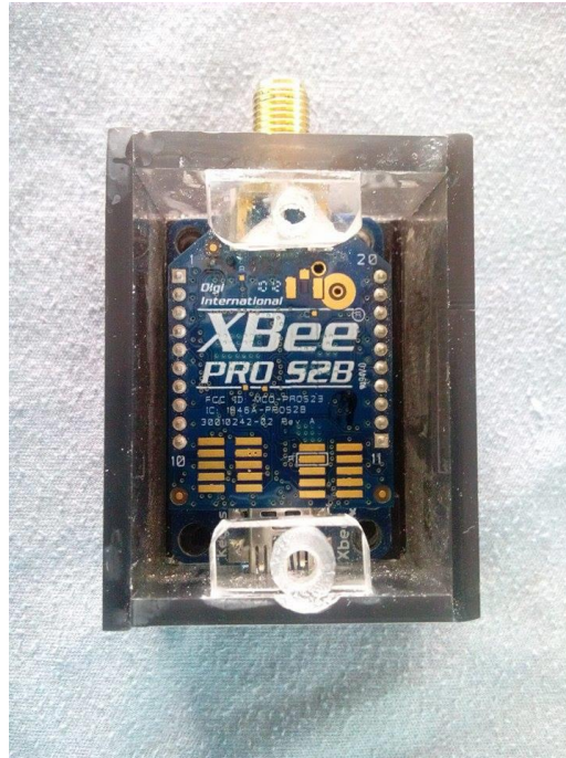
Figura 28. Módulo XBee PRO serie 2B (Protocolo ZigBee).
