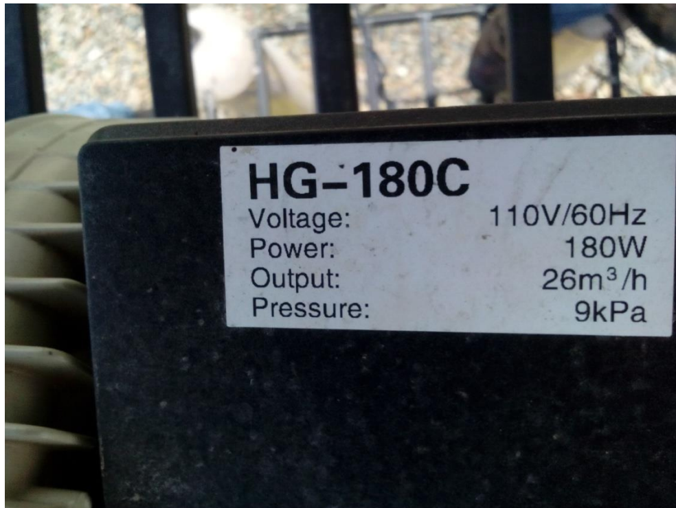
Figura 2. Blower's- Especificaciones (Granja Experimental- Usco)
