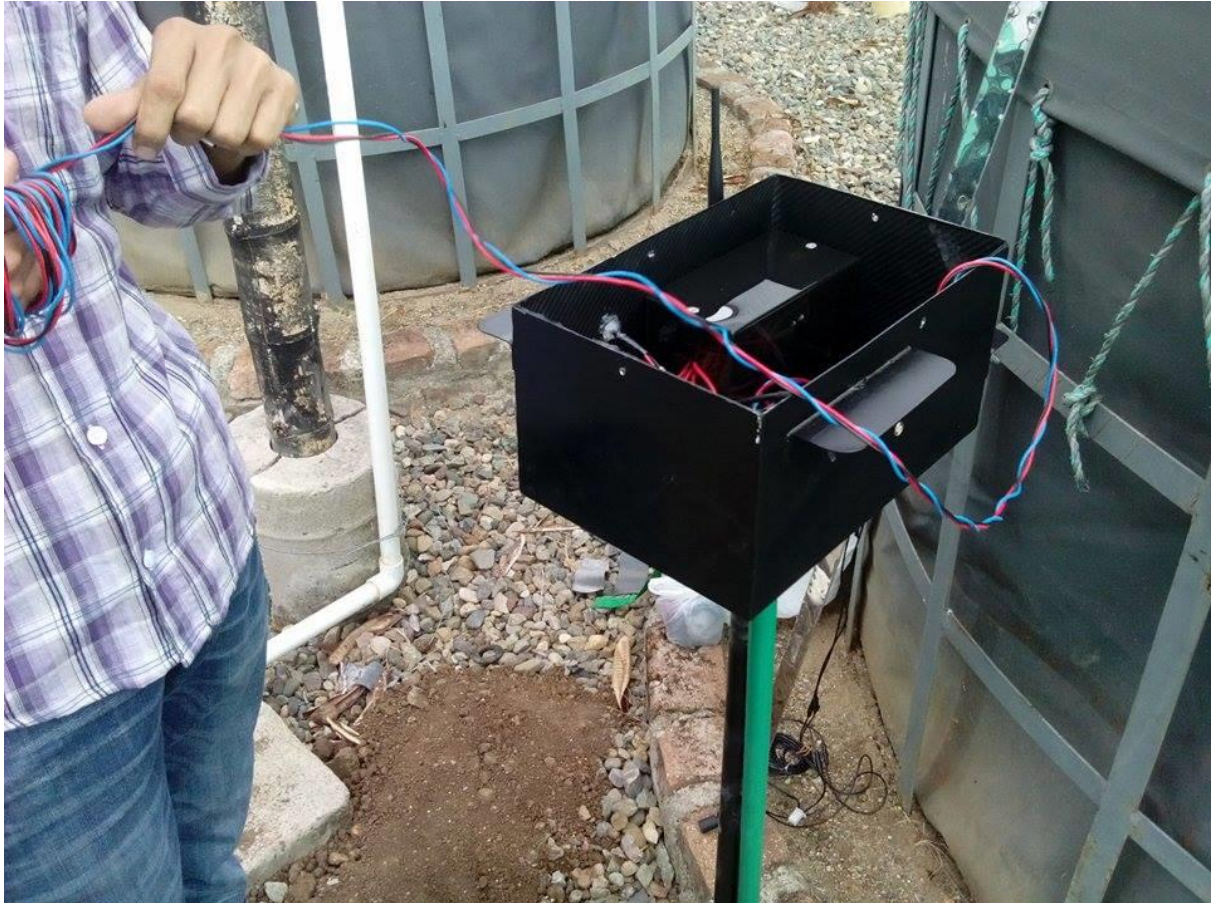
Figura 66. Implementación de sonda de humedad en el sistema
