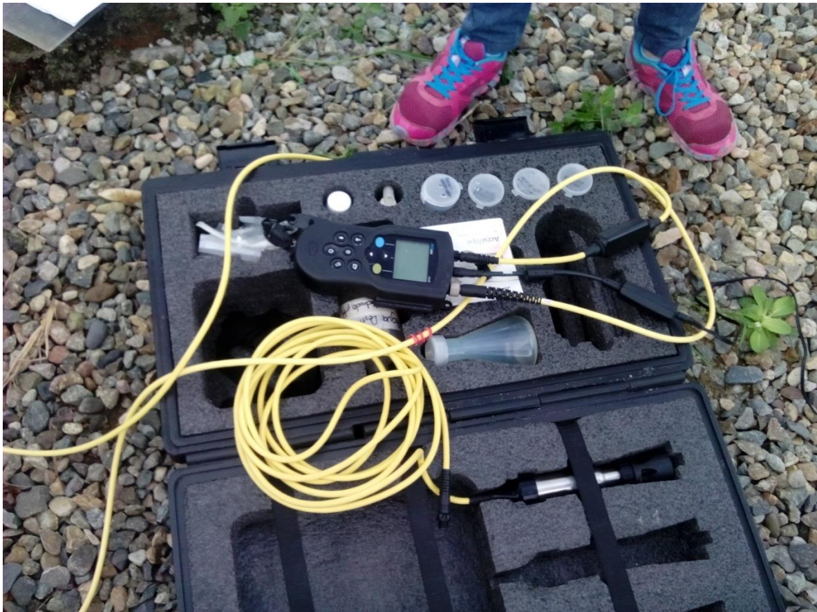
Figura 7. Multiparamétrico variables físico-químicas (Granja Experimental-USCO)
