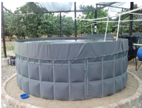
Figura 1. Tanque de cultivo de peces (Granja experimental-USCO)
