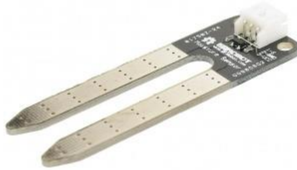
Figura 20. Sensor de humedad
