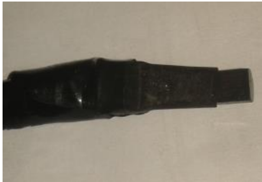
Figura 34. Protección del sensor DS18B20 a la humedad.
