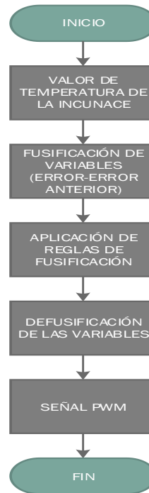
Figura 49. Algoritmo de controlador difuso de temperatura.
