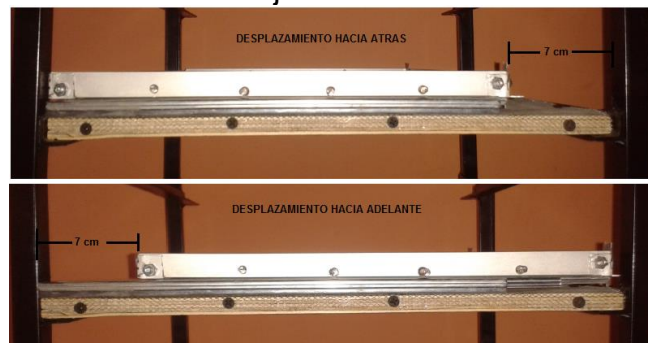
Figura 27. Desplazamiento de bandejas secundarias.
