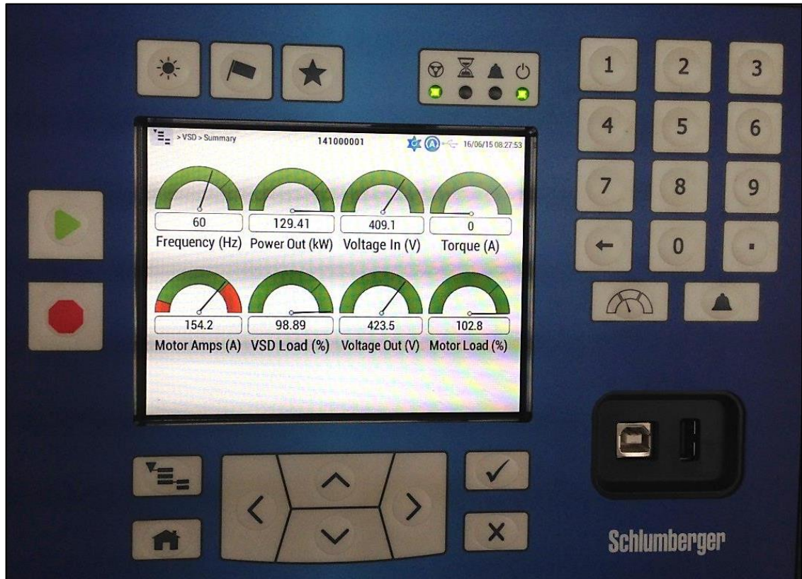
Figura 9.6 Instruct Registrando Variables Durante Prueba con Carga de VSD
