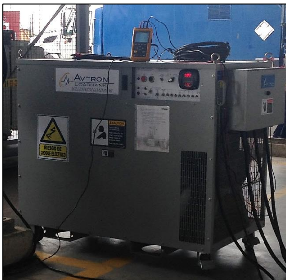
Figura 9.1 Banco de Carga para Pruebas de Variadores de Velocidad
