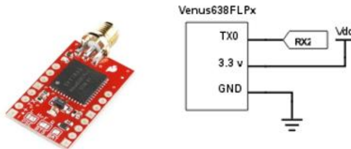
Figura 15. GPS Venus y su conexión
