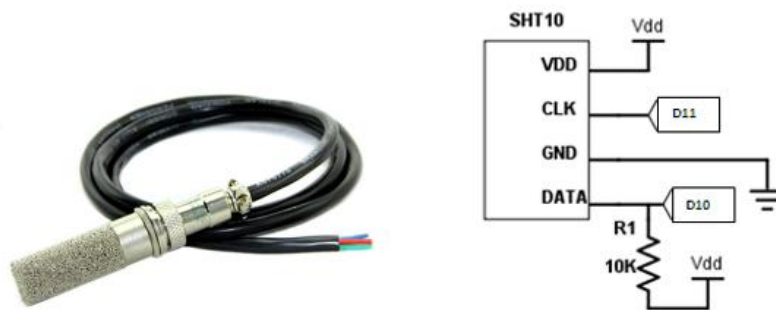
Figura 17. Conexión SHT10 y su conexión
