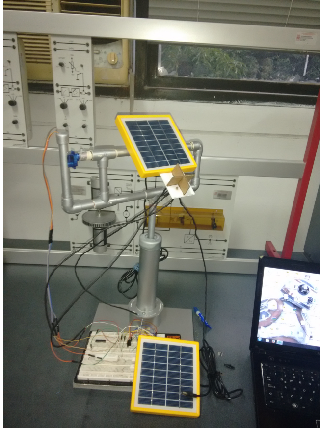
Figura 12. Estructura móvil modelo a pequeña escala
